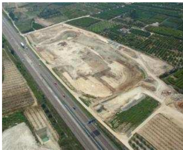
Balsa de regulación de Llanera de Ranes de 51.000 m 3 de capacidad A. I.
