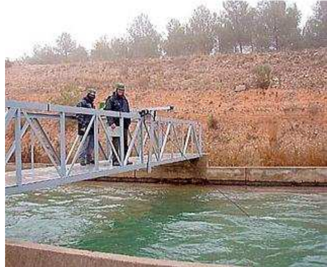
Medición de aforo de agua en uno de los canales del postrasvase A. I.
